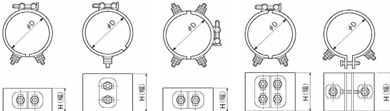
バンドヒーターは取付方法、及び製作上の都合により1ピース型・2ピース型がありその取付状況によって形式を選択いたします。
